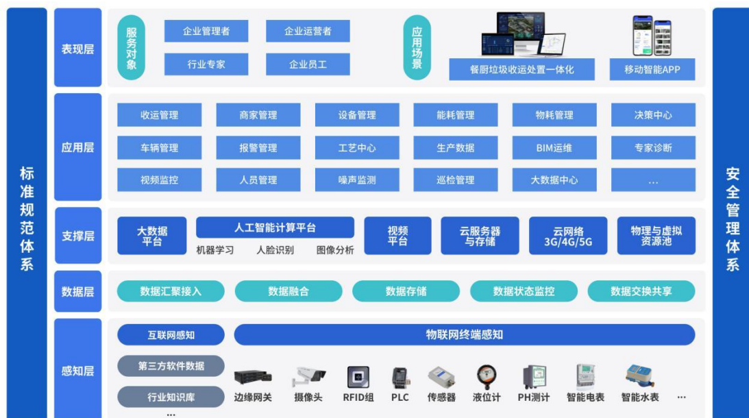
图 34 餐厨废弃物智慧收集、运输与资源化处理系统总体架构
