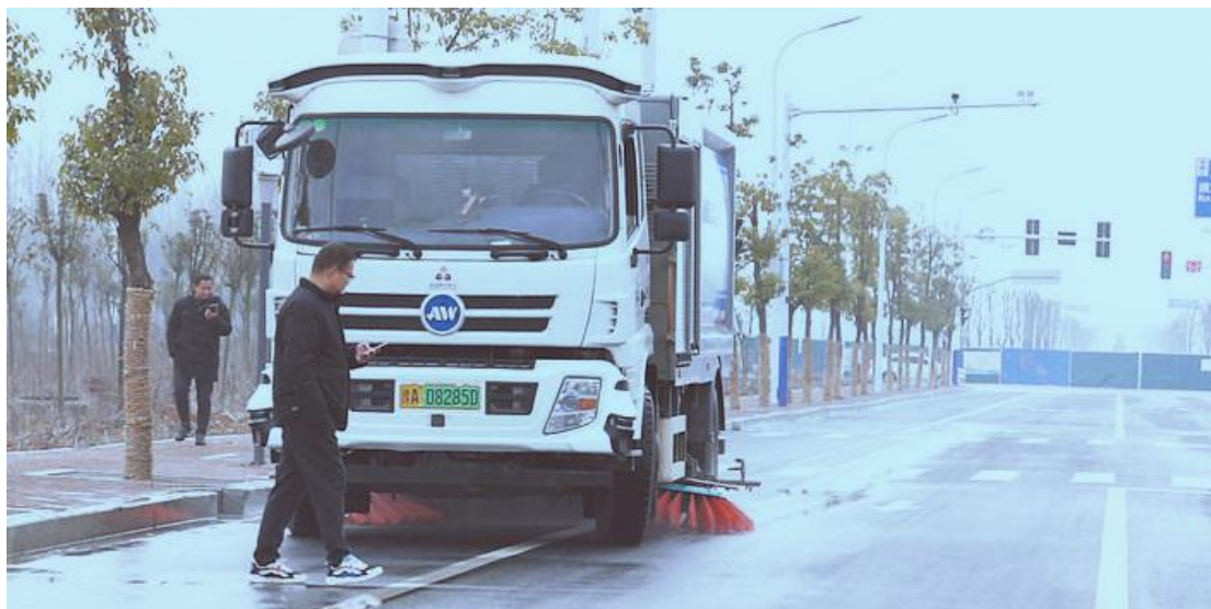
图 14 启迪数字环卫无人清扫车自动规避行人
